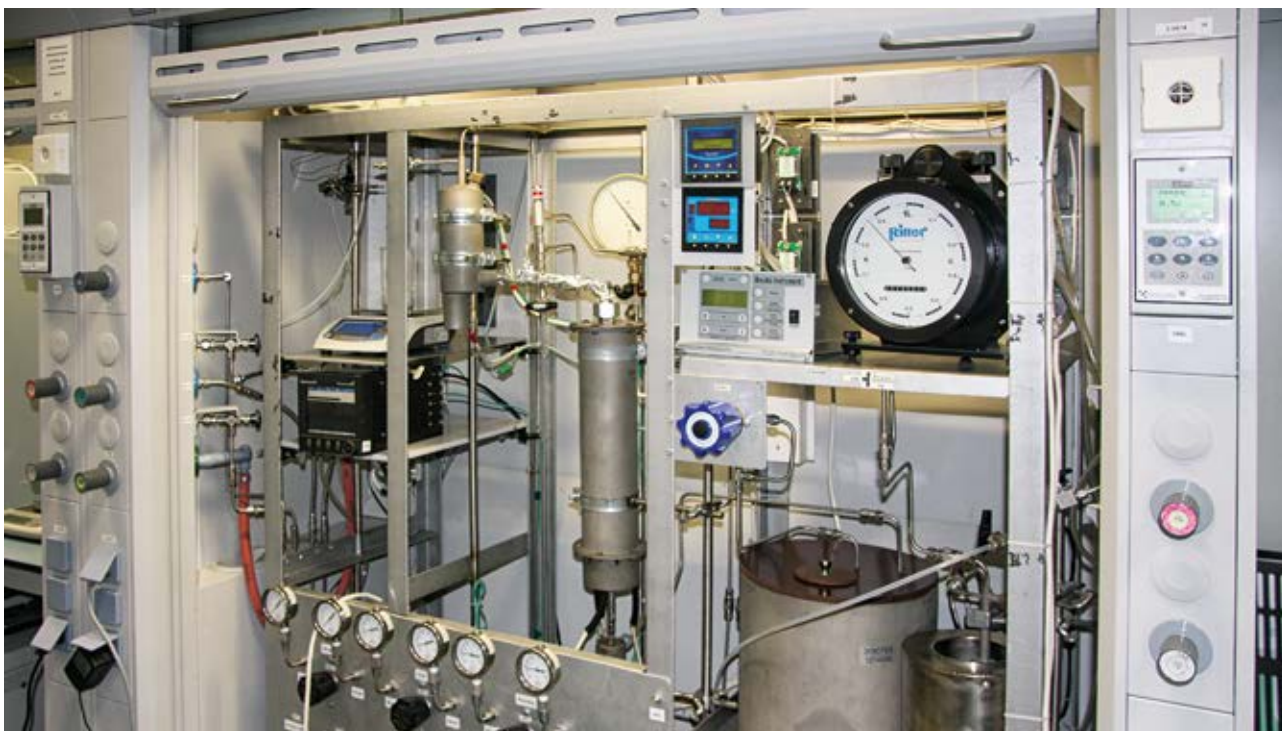
Экспериментальная установка моделирования гидрокаталитических процессов нефтепереработки
